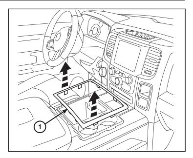
48. Eliminar elementos de fijación (1) en el borde frontal del centro panel de la cubierta de la consola (2). Retire la tapa de protección.
