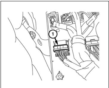
42. Retire la carcasa (2) para tener acceso a los bloques de terminales (1).
