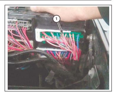
30. Superponga los hilos de los cables dentro de la pinza empalme (1).
