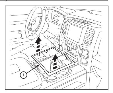
48. Enlever les fixations (1) au niveau du bord avant du centre panneau de couvercle de la console (2). Retirez le panneau de couverture.
