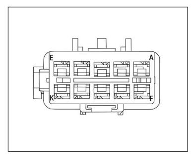
41. Libere y retire el conector C5 (1) del Módulo de control de la carrocería (BCM).
