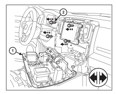
52. Retirer l'ensemble de la radio (1) de tableau de bord. Déverrouillez le le connecteur (2) à l'arrière de la radio et déconnecter.
