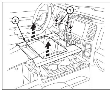
49. Retirer la vis (1) à partir du trou de stockage sur le côté droit du panneau de garniture de tableau de bord. Soigneusement levier sur le panneau de garnissage (2).
