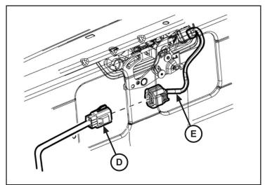
NOTA: Si el vehículo no está equipado con un actuador de seguro, sujete con cinta adhesiva el conector del actuador de seguro.
