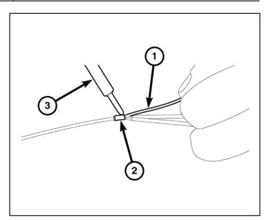
33. Centre el tubo termoretráctil (2) sobre la unión de la soldadura y aplique calor con una pistola de calor. Caliente la unión hasta que el tubo esté bien sellado y salga (1) sellador de ambos extremos del tubo.
