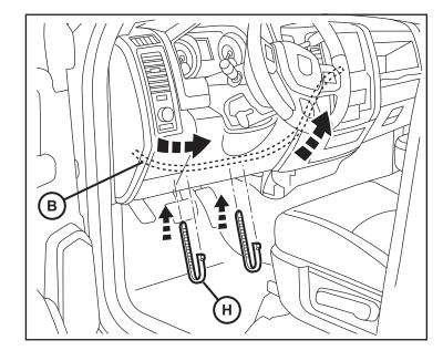
54. Pase el extremo de tres clavijas del mazo de la radio (B) hacia arriba en el centro y hacia fuera a través de la abertura de la radio.
