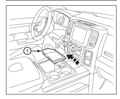
47. Déposer la garniture de bord (1) à partir de la console centrale, couvrir panneau.
