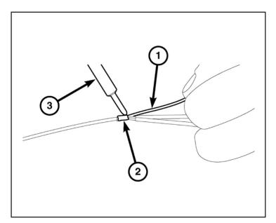
33. Centrez le tube thermorétrécissable (2) sur le joint du métal d'apport et chauffez-le au moyen d'un pistolet thermique. Chauffez le joint jusqu'à ce que le tube soit bien scellé et que le mastic (1) sorte des deux extrémités du tube.
