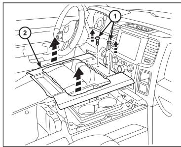
49. Retire el tornillo (1) del orificio de almacenamiento en el lado derecho del panel de ajuste de la rociada. Cuidadosamente saque el panel de ajuste (2).
