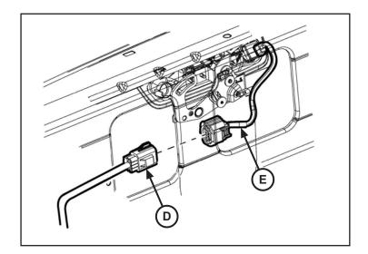
NOTA : Placez le connecteur d'actionneur de serrure vers l'arrière à l'aide de ruban adhésif si le véhicule n'est pas équipé d'un actionneur de serrure.
