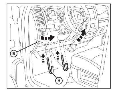
54. Insérez l'extrémité à trois broches de fil de radio (B) à travers la console centrale et à l'extérieur à travers l'ouverture de la radio.
