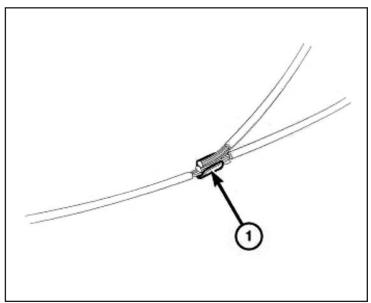
31. Con la herramienta de fijación Mopar® (1) o una equivalente, fije la pinza de empalme y los cables.
