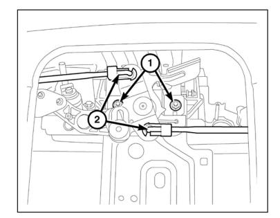
NOTA: Si el vehículo está equipado con el actuador de seguro de la compuerta trasera, debe retirar y transferir los dos cables del conector existente del lateral de la carrocería de la compuerta trasera al conector del mazo de cables de la carrocería (A) provisto. Consulte el gráfico para obtener más información.
