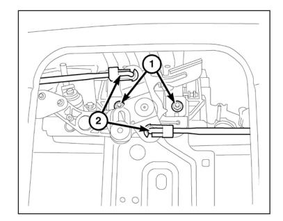
NOTA: Si le véhicule est équipé de l'actionneur de serrure de hayon, vous devez retirer les deux fils du connecteur de hayon du côté carrosserie existant et les transférer au connecteur de faisceau de carrosserie fourni (A). Consultez le graphique pour obtenir de plus amples renseignements.
