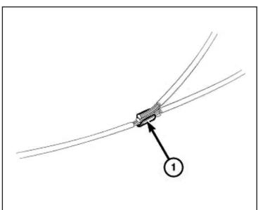
31. À l'aide de l'outil de sertissage MoparMD (1) ou d'un outil équivalent, sertissez l'agrafe de jonction de fil et les fils ensemble.
