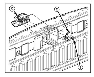
NOTA: Si le véhicule est équipé d'un actionneur de serrure électrique, retirez le faisceau d'actionneur de serrure et mettez-le au rebut.
