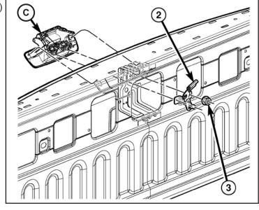
NOTA: Si el vehículo está equipado con un actuador de seguro eléctrico, retire y descarte el mazo de cables del actuador de seguro.
