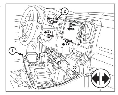
52. Retire el conjunto de radio (1) desde el tablero. Retire la gran connnector en la parte trasera de la radio.
